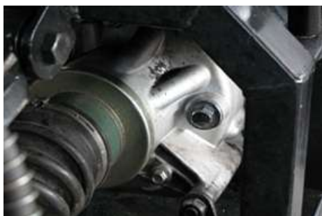
Zadný obmedzovač rýchlosti , kontrola oleja
