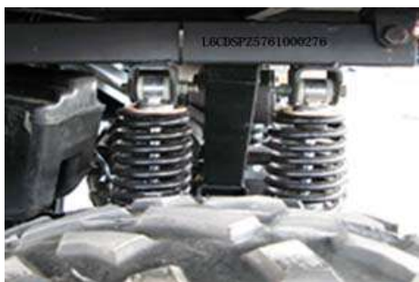
Umiestnenie čísla VIN (na ráme nad pravým zadným kolesom)
