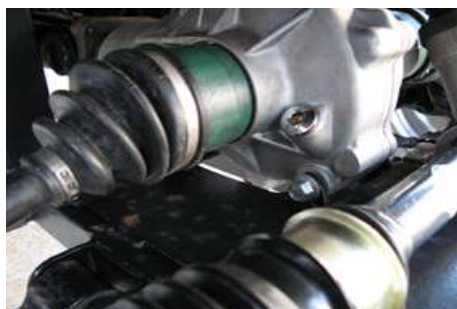
Predný obmedzovač rýchlosti, kontrola oleja
