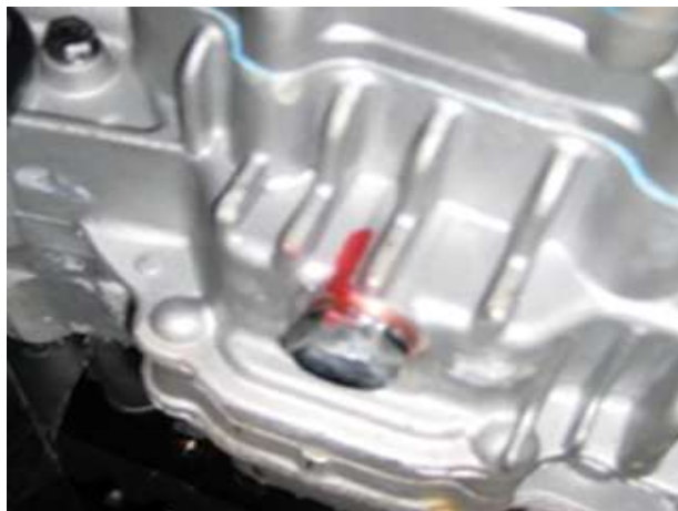
Výpustná skrutka oleja (spodná časť motora)
